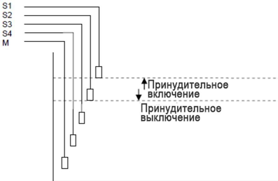
При превышении уровнем воды уровня датчика 1 принудительно включается циркуляционный насос до тех пор, пока уровень не опустится ниже уровня датчика 2.
