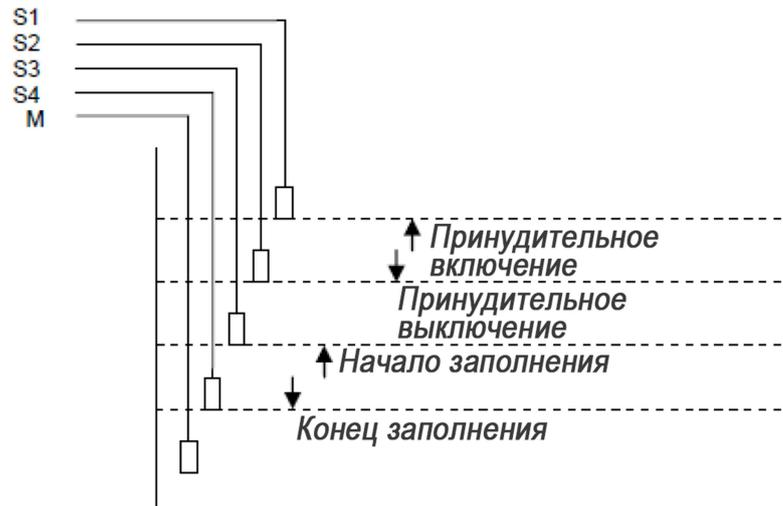
AM008RNV использует 5 датчиков уровня. Датчики должны быть расположены в ёмкости таким образом, чтобы уровень принудительного включения насоса (S1) был ниже уровня переполнения буферной ёмкости.
