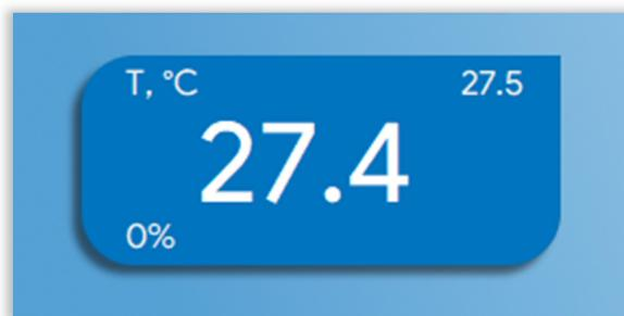
В левом верхнем углу "плитки" отображается название контура — "T", в правом верхнем углу — уставка, в центре — фактическое значение, в левом нижнем углу — процент открытия клапана. При выходе фактического значения за аварийные, цвет значения становится красным.
