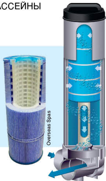
■ Для восстановления картриджного фильтра достаточно промыть картридж под струей воды
