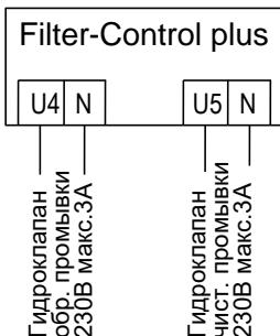
К клемме U4 и N можно подключить штанговый гидроклапан (230В) для проведения обратной промывки.
