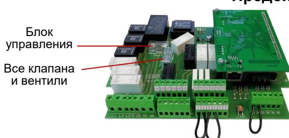
Электронная часть защищена плавким предохранителем (0,5А) находящимся на плате внутри блока управления. Выхода управления клапанами и вентилями защищены предохранителями 3,15А.
