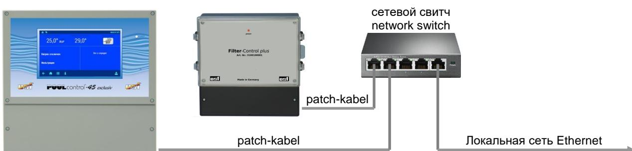
После соединения кабелей и подачи питания необходимо провести логическую связь между устройствами. Более подробно в разделах «Конфигурация компонентов бассейна» обоих устройств. После этого оба **BSI** - устройства обмениваются данными по локальной сети.
