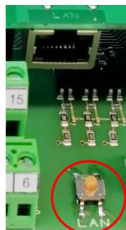
В течение этого времени нужно нажать на кнопку LAN находящуюся на плате блока Filter-Control plus, чтобы разрешить связь двух блоков. При нажатии кнопки LAN индикатор на передней панели этого блока начинает моргать зеленым цветом, сигнализируя о включенном режиме «установка связи между блоками». Зелёный индикатор моргает вплоть до установки связи между блоками, но не больше 2 минут.
