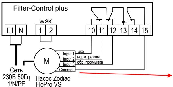
В насосе Zodiac FloPro VS регулирование скоростью подсоединяется к клеммам на обратной стороне пульта управления. Для всех режимов нужно определить желаемую скорость. Эко-режим (Input 1), нормальный режим (Input 2) и режим обратной промывки (Input 3)
