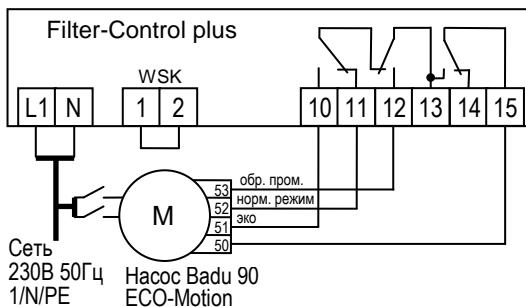
В настройках на самом насосе нужно активировать внешнее управление фиксированными скоростями „Festdrehzahlen digital“ со «статичным» типом сигнала «Dauersignal». Для скоростей N1, N2 и N3 необходимо выбрать желаемые скорости эко-режима, нормального режима и для обратной промывки.
