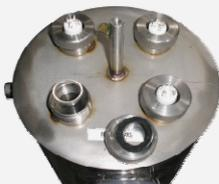
С пальцем внутри трубки, вставить ее в прибор сверху корпуса к нижней части реактора..
