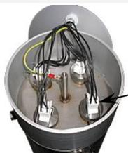
Соединить вновь каждый разъем лампы.. (Не применяйте больших усилий к разъему на его месте : Существует особое направление соединения) и зажмите разъем нержавеющими гайками.
