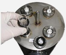
Удерживайте кварцевую трубку и извлеките ее полностью, следя за тем, чтобы она правильно входила вдоль оси..
