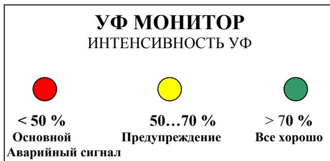
Этот монитор показывает степень понижения интенсивности излучения лампы из-за ее срока службы, но может также свидетельствовать о загрязнении на кварцевой трубке или на элементе измерения излучения УФ-С.
