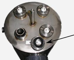
Отвернуть гайку из нержавеющей стали
