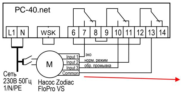
В насосе Zodiac FloPro VS регулирование скоростью подсоединяется к для этого предназначенным клеммам на обратной стороне пульта управления. Для всех режимов нужно определить желаемую скорость. Эко-режим (Input 1), нормальный режим (Input 2) и режим обратной промывки (Input 3)
